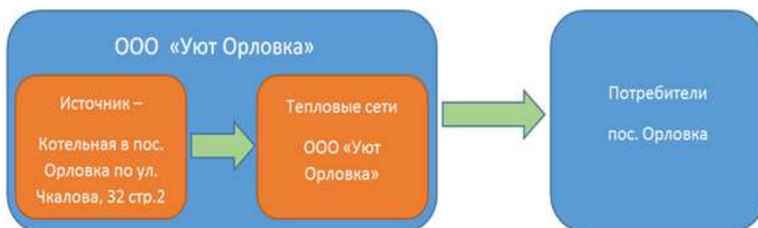
Рисунок 1.3 – Функциональная структура теплоснабжения п. Орловка
