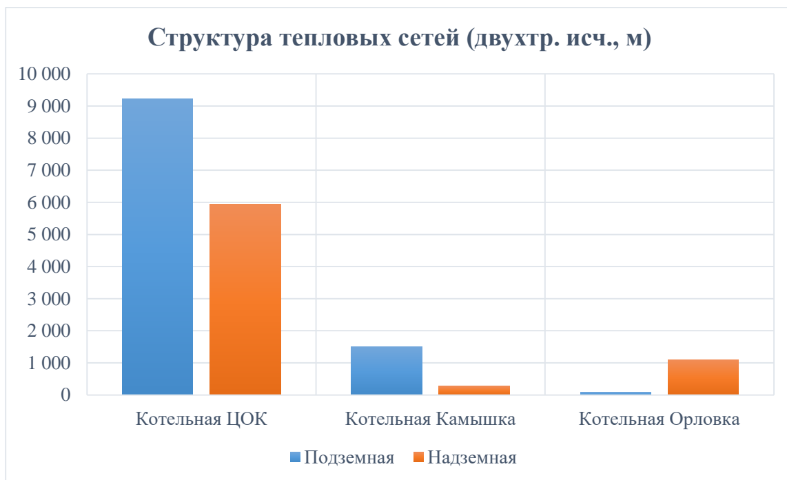
Рисунок 3.1 – Структура тепловых сетей по видам прокладки
