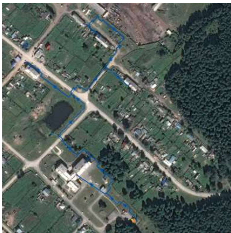
Рисунок 3.8 – Схема теплоснабжения от котельной в п. Орловка (ООО «Тепло П»)
