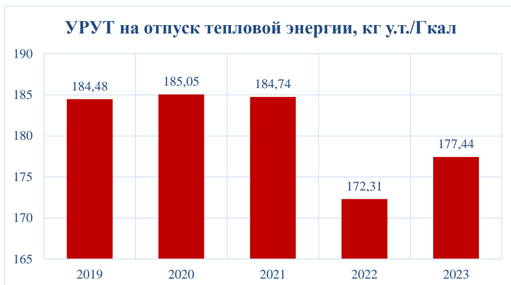
Рисунок 10.2 – Динамика изменения удельного расхода условного топлива на отпуск тепловой энергии ТЭЦ АО «РИР»
