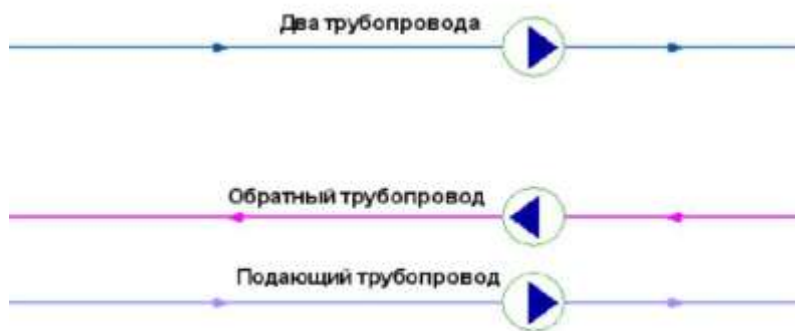
Рисунок 7 – Однолинейное изображение (вверху) и внутреннее представление (внизу) сети с насосными станциями
