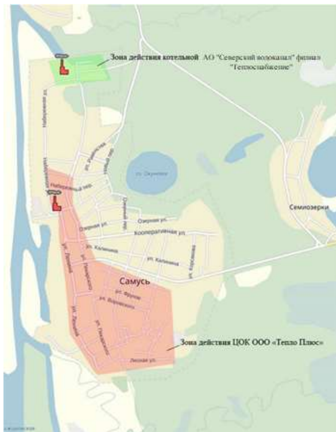
Рисунок 4.2 – Существующие зоны действия центральной отопительной котельной ООО «Тепло Плюс» (красный цвет) и котельной по ул. Камышка (зелёный цвет)
