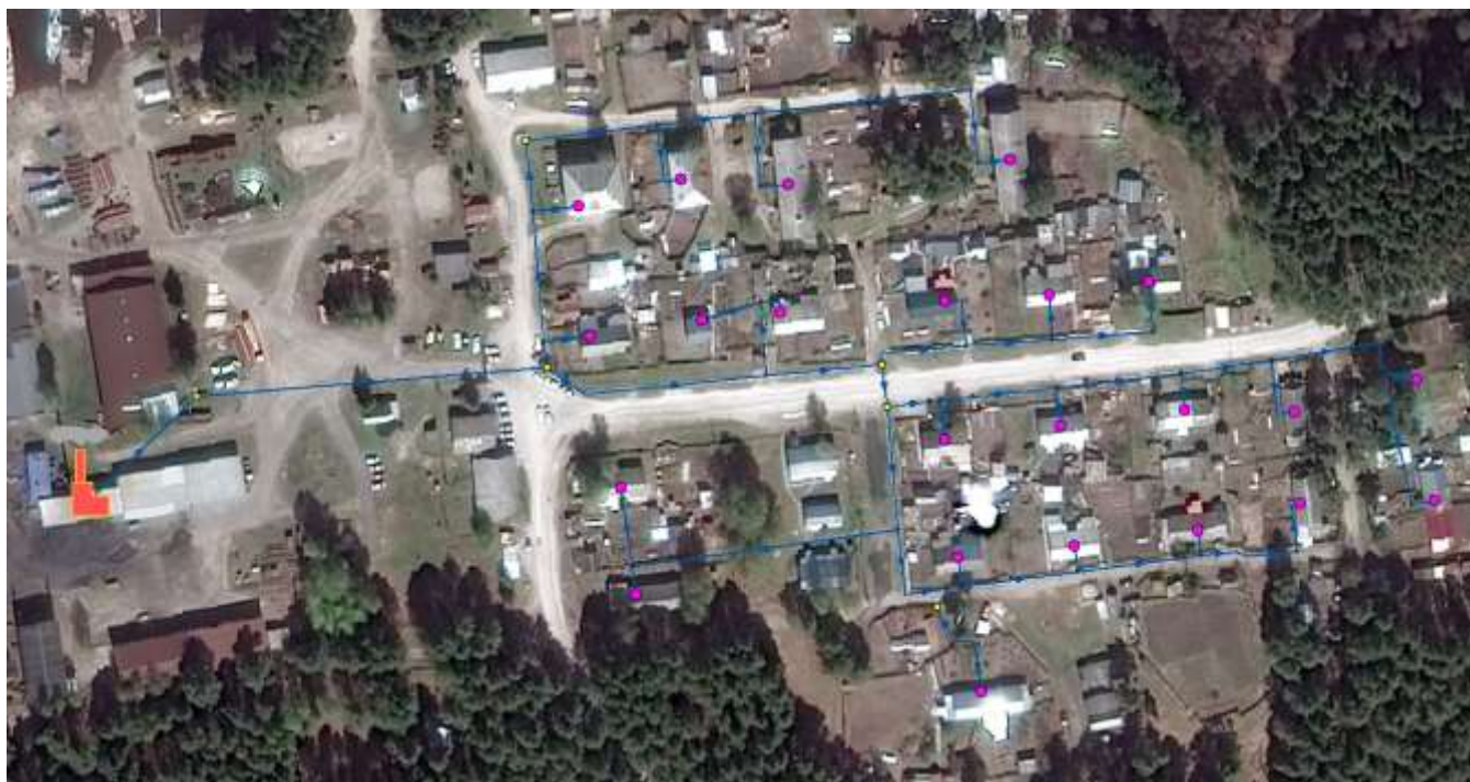
Рисунок 3.7 – Схема теплоснабжения п. Самусь от котельной по ул. Камышка (ООО «Тепло П»)
