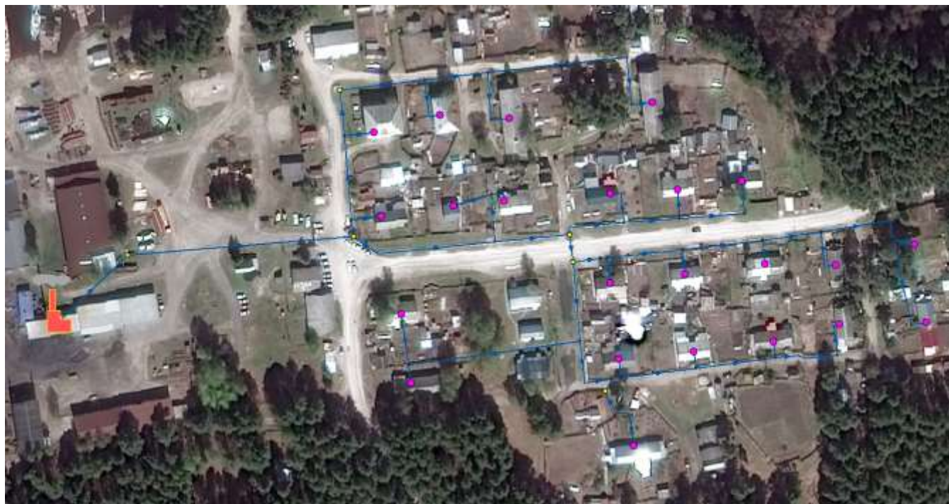
Рисунок 3.7 – Схема теплоснабжения п. Самусь от котельной по ул. Камышка (МКП «СВК»)
