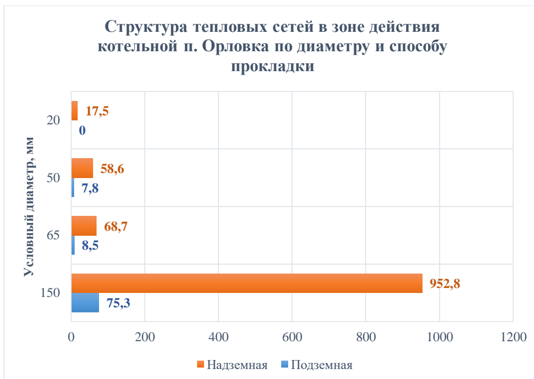
Рисунок 3.4 – Структура тепловых сетей в зоне действия котельной п. Орловка
