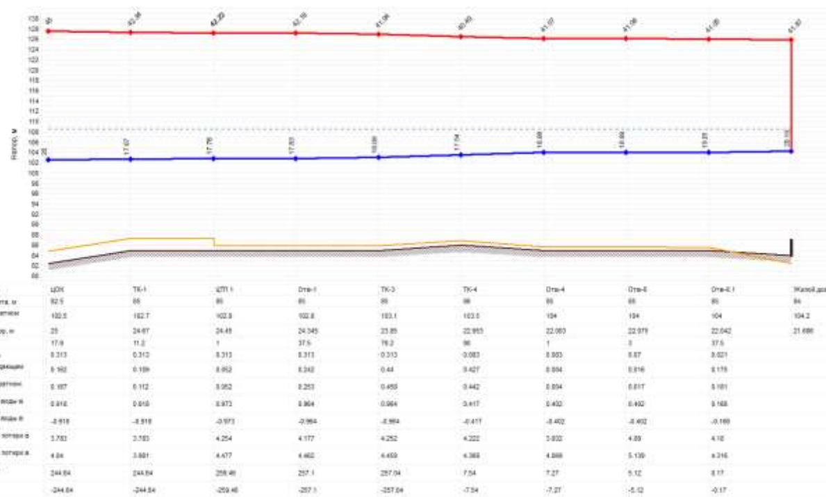
Рисунок 3.14 – Пьезометрический график по направлению от котельной «ЦОК»
