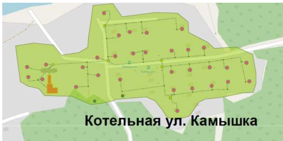
Рисунок 4.3 – Существующие зоны действия центральной отопительной котельной по ул. Камышка МКП «СВК»
