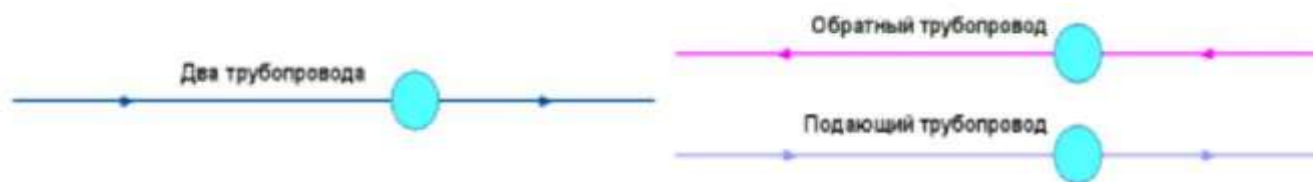
Рисунок 11 – Однолинейное изображение (слева) и внутреннее представление (справа) сети с дроссельными шайбами
